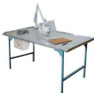
стол для размагничивания и предварительного контроля
