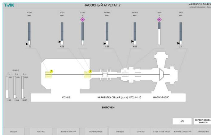
При нажатии на значение «Наработка общая» открывается окно наработки по всем узлам. Также дефектные узлы подкрашиваются иконками с различной цветовой градацией в зависимости от характера дефекта.
